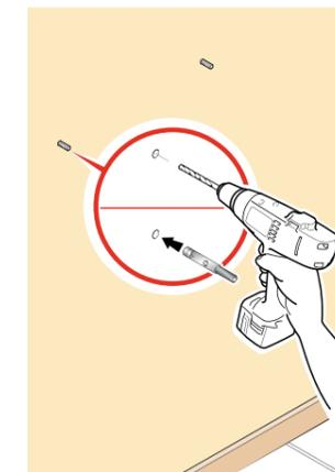
3 Fixez fermement l'étrier supérieur au mur. Utilisez des fixations de Ø 10 mm minimum
