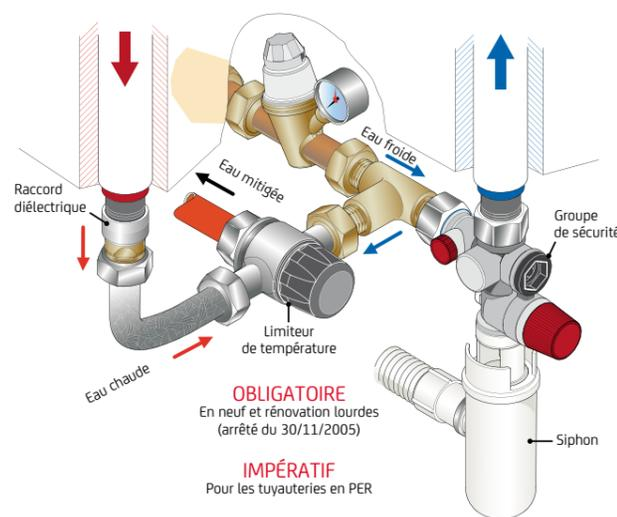
La tuyauterie doit supporter une Température de 100 °C et 10 bars. Dans le cas contraire, mettre un limiteur de température après le raccord diélectrique.
