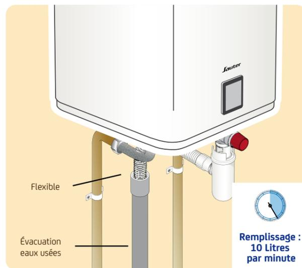
Ouvrez l'eau pour remplir le chauffe-eau et testez l'étanchéité. Pour un remplissage complet, ouvrez un robinet d'eau chaude pour purger l'air du chauffe-eau.
