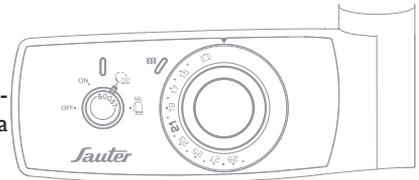
*Autre exemple : La molette D est positionnée sur 21° C. La température affichée sur votre thermomètre est de 18° C. La valeur d'étalonnage sera donc de -3° C (3 crans).*
