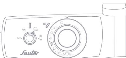
Ander voorbeeld: Het knopje D staat op 21 °C. De temperatuur geeft 18°C aan. De ijk waarde bedraagt du -3°C (3 standen). Indien u het apparaat op wenst te zetten , moet u het knopje draaien tot aan de aanslag. Maar als u het pictogram in lijn zet met het merkteken ▼, verkrijgt u een temperatuur van 15°C.
