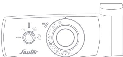
*Autre exemple : La molette D est positionnée sur 21° C. La température affichée sur votre thermomètre est de 18°C. La valeur d'étalement sera donc de -3°C (3 crans).*
