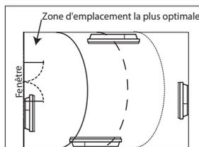
Zone d'emplacement optimale pour l'utilisation de la fonction Détection d'ouverture et de fermeture fenêtre.
