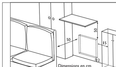
Respectez les distances minimales avec le mobilier pour l'emplacement de l'appareil.
