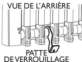
3 Faites pivoter la patte de verrouillage de façon à pouvoir la fixer au mur.
