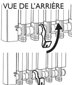
4 Vissez la patte de verrouillage au mur pour garantir un bon maintien du radiateur.
