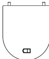
Vous devez insérer la pile (CR2430) dans la radio commande digitale dans les 10 minutes qui suivent l'alimentation électrique du radiateur sèche-serviettes.
