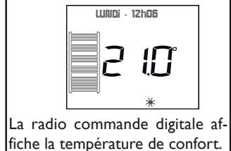
Lors de la première mise en route, l'appareil est réglé en mode Confort à 21°C.
