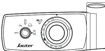
Autre exemple : La molette **D** est positionnée sur 21° C. La température affichée sur votre thermomètre est de 18° C. La valeur d'étalonnage sera donc de -3° C (3 crans).
